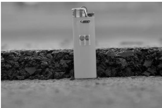
Figura 2: Espesor de la capa de rodadura tipo SMA 10
